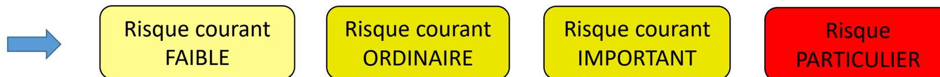
→ 4 Risques = 4 besoins en eaux différents (30m<sup>3</sup>/h, 60m<sup>3</sup>/h, 120 m<sup>3</sup>/h.....)
